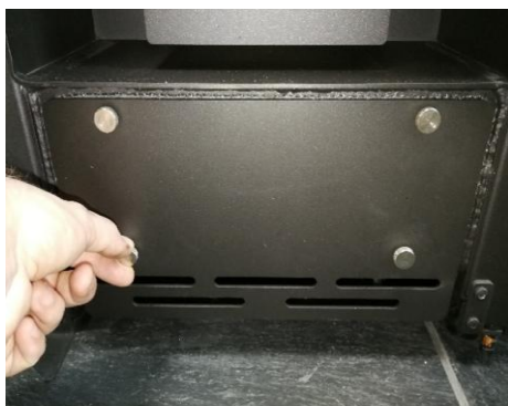
Picture 1 : Dévisser la plaque rectangulaire afin d'accéder au déflecteur.
